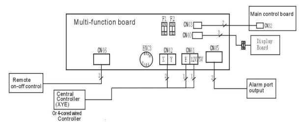
Fig. 19 — Wiring Diagram
