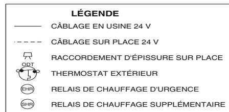
Fig. 11 – Schémas de câblage génériques (consultez les instructions d'installation du thermostat pour connaître les combinaisons spécifiques des appareils)
