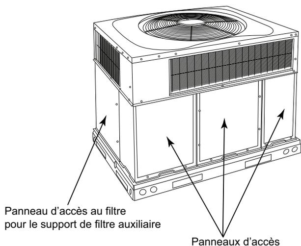
**Fig. 2 – Panneau d'accès de l'appareil**
