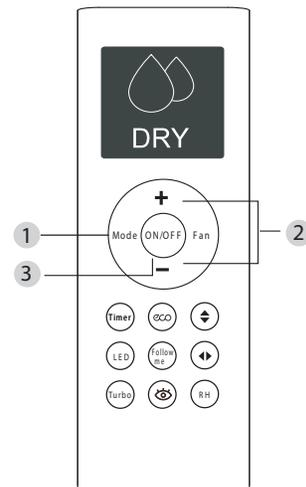
Fig. 10 – Fonctionnement en mode DÉshumidification
