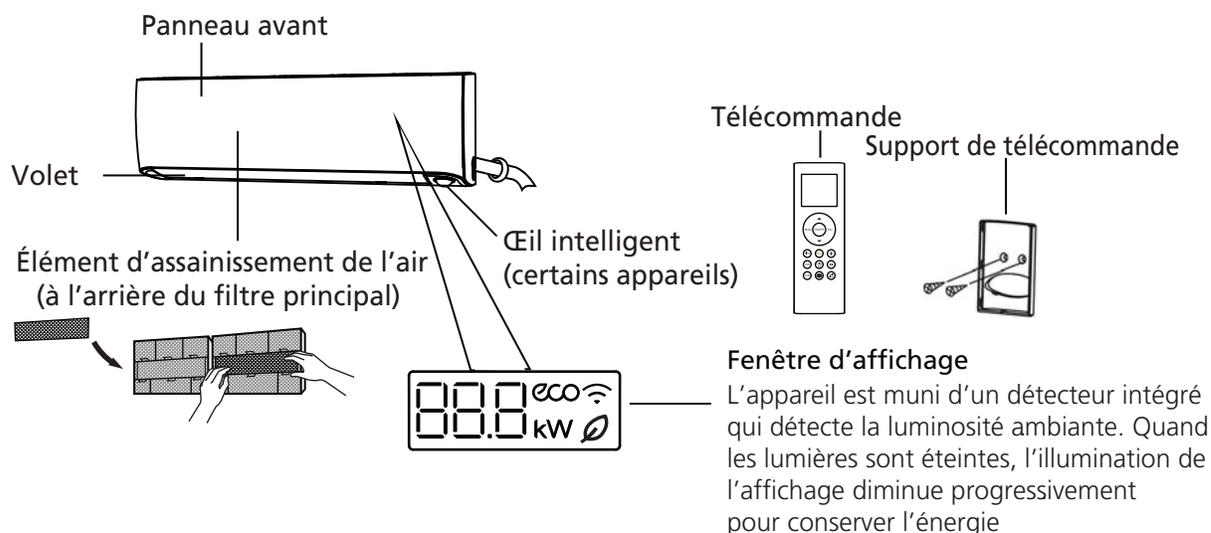
Fig. 1 – Module intérieur
