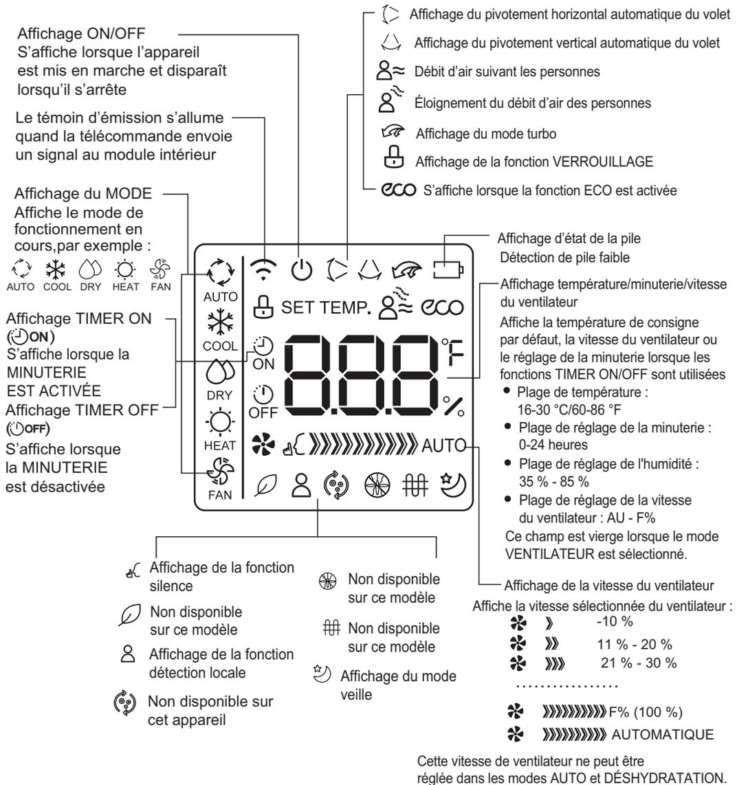
Fig. 4 – Affichage de l'appareil
